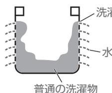
洗濯物の水は洗濯・脱水槽の穴から抜けます。
