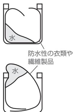
洗濯・脱水槽が回転しても水が防水性の衣類や繊維製品から抜けないため、水が片寄って大振動を引き起こします。
