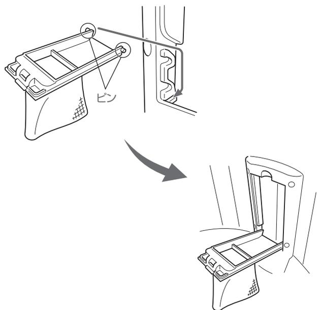
矢印のように糸くずフィルターの左右のピンを差し込み、取り付けを行ってください。(取り外しは逆の手順で行ってください。)
