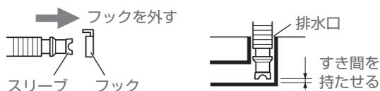
※排水ホースは排水時の水の力や振動などで動くことがあるため、排水口にしっかりと差し込み抜けを確認してください。
